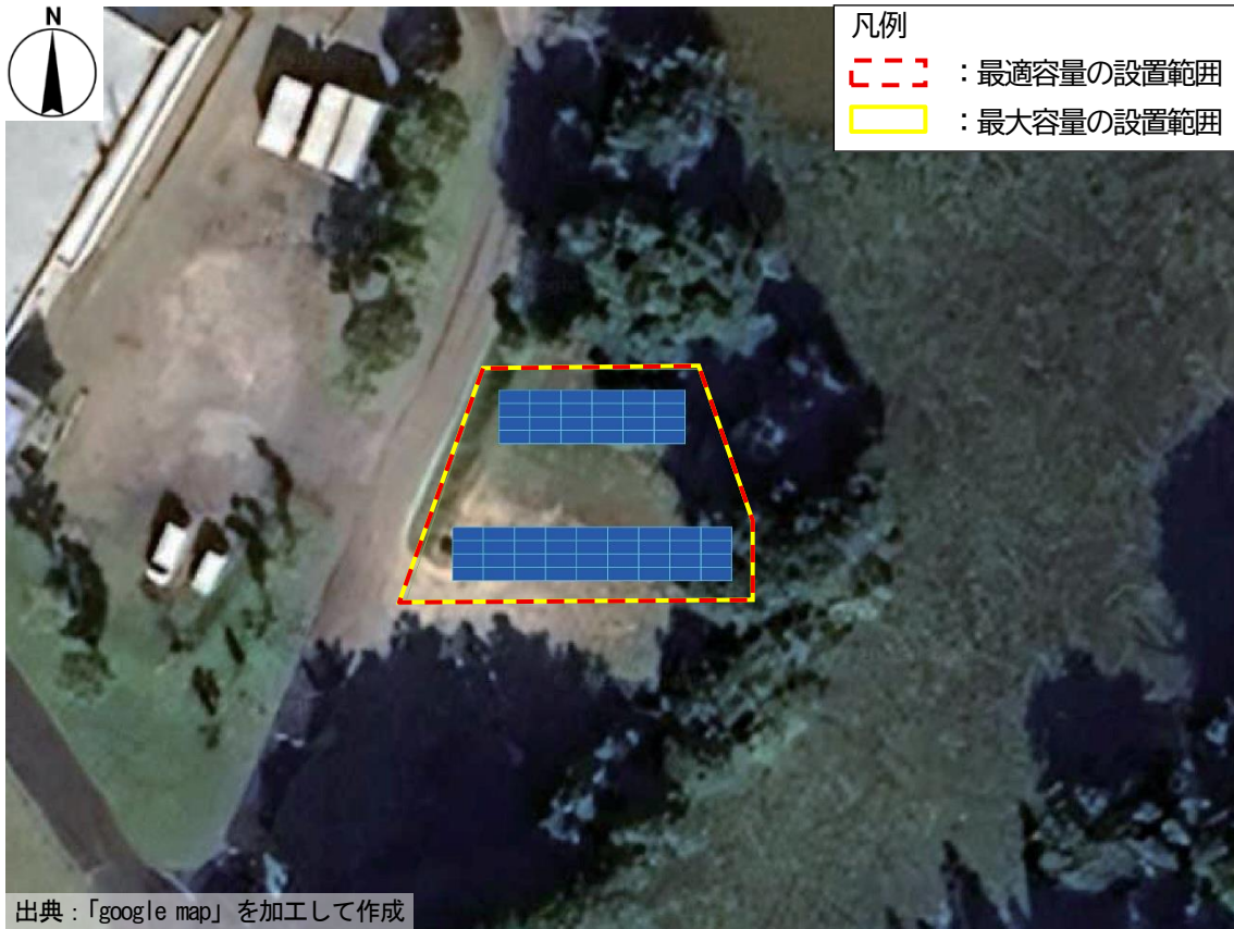
図4-3(6) 太陽光パネル配置図(No. 7 山本健康保養センター(ゆうぱる))
