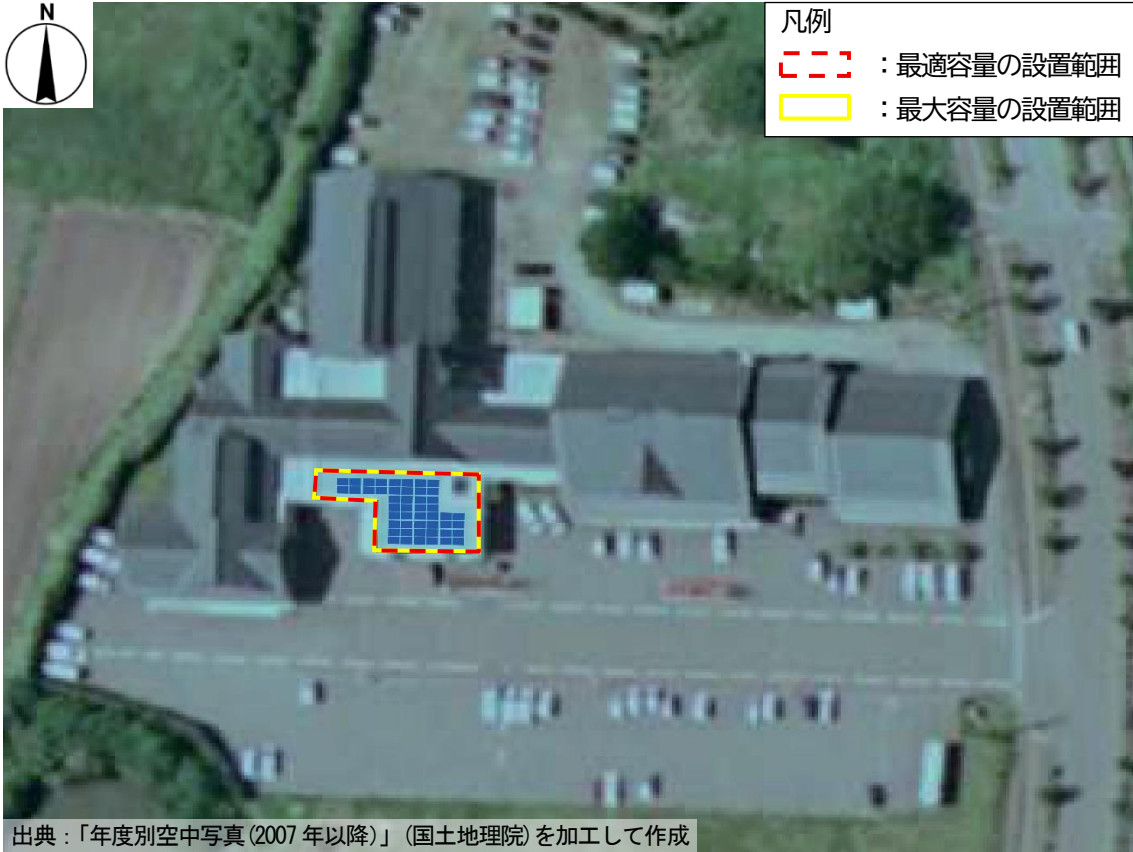
図4-3(13) 太陽光パネル配置図(No. 16 三種町地域福祉センター)
