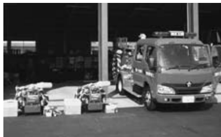
▲更新された小型動力ポンプと消防ポンプ車
